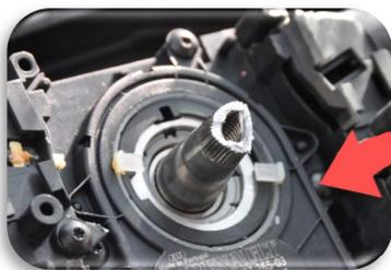
ステアリングコラムは中空のため工具で破壊できます
